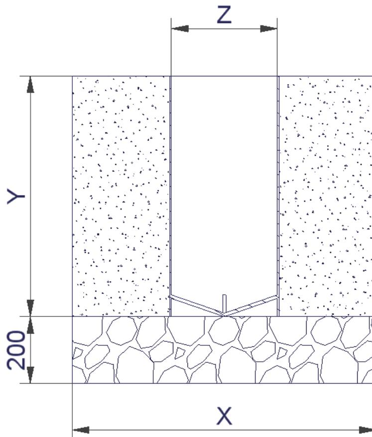
Baumständer aus Stahl verzinkt, mit schraubbarem, geriffeltem, bodenbüdigem Deckel.
